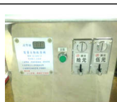
投幣式計電量機 (依用電電量計量)
