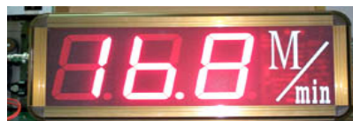
4" 米速表(工廠輸送帶顯示用)
